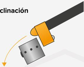
**10** Para encender áreas de difícil acceso, levante la muñeca hacia arriba para lanzar fuego a distancias mayores (si la mezcla no se enciende al caer, aumentar la proporción de gasolina en la mezcla).
